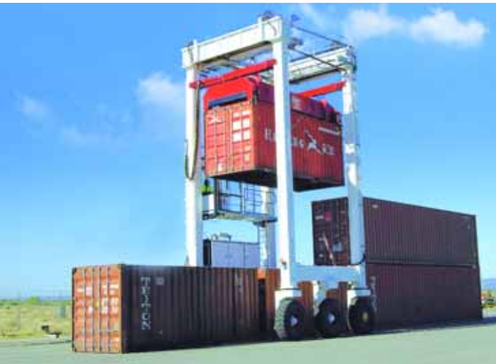
Hoch gestapelt: Die Portalhubwagen können bis zu drei Längen übereinander stapeln. (Fotos: MH-Trade)
