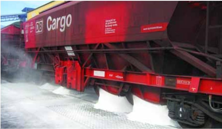
Steht nicht nur so da: Der Zug entlädt Soda in die neue Mittenentleerungsanlage im Hafen von Wismar.
