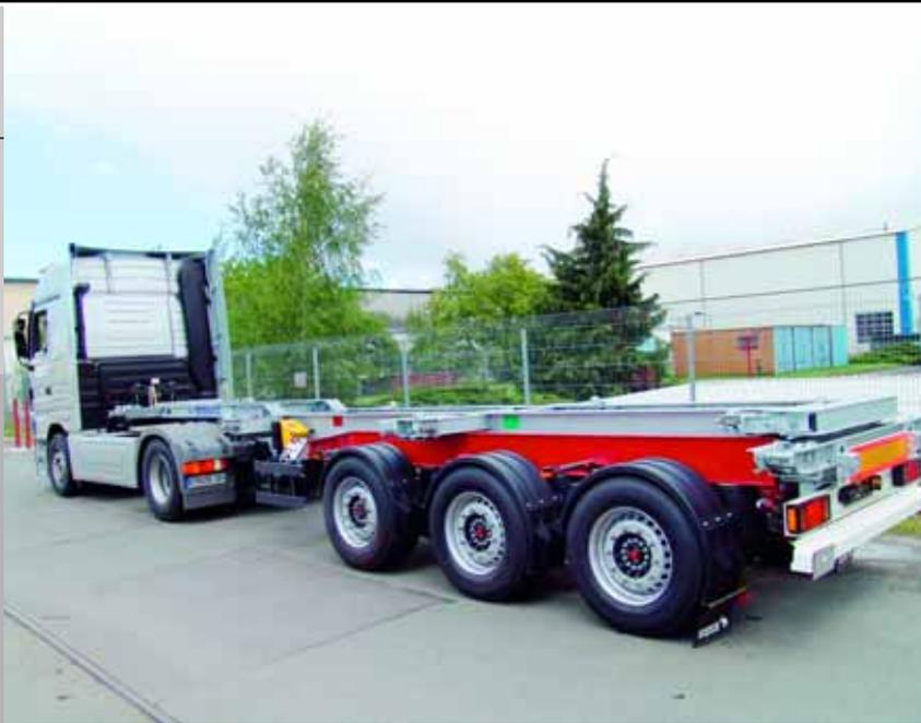
Auf Vielseitigkeit setzt auch M&V Trailer. Deren neuester Containersattelanhänger mit der Typ-Bezeichnung Euro 802 kann vom 20'- bis zum 45'-Container alle Behältergrößen transportieren. Dazu ist er mit insgesamt drei Teleskop-Einrichtungen ausgestattet. Mit einem Heck- und Mittelausschub, die pneumatisch betätigt werden und zusätzlich mit einem per Hydraulikhandpumpe bedienbaren Frontausschub.
