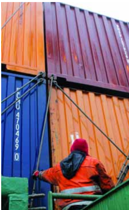
HARTE ARBEIT: Das Verlaschen der über Deck gestauten Container ist Sache der Hafendarbeiter.
