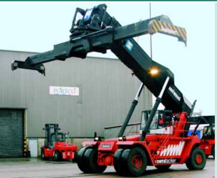
GRÖßERE AUFGABEN: Zum Bewegen der Container auf den Terminals stehen drei Reachstacker zur Verfügung.
