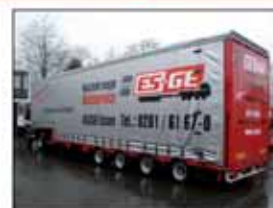
3 – 6-achsige Satteltiefelader in Niedrigbauweise mit Curtainsider-Aufbau, 800 mm Ladehöhe, anheb- und verbreiterbar auf ca. 4.600 mm
