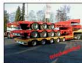
2 – 8-achsige Satteltiefelader, teleskopierbar, hydr. oder nachlaufgelenkt
