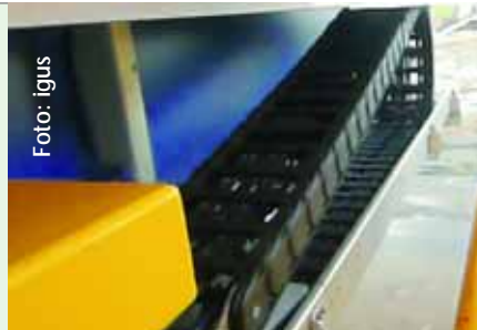
Schnelle Kette: Energieketten-System „P4“ auf RMG-Kran im Binnenhafen Duisburg.
