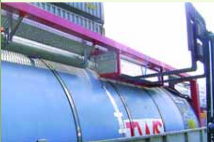
Von oben bedienbar: Die Elektro-Glycolheizung am Tankcontainer von TWS.
