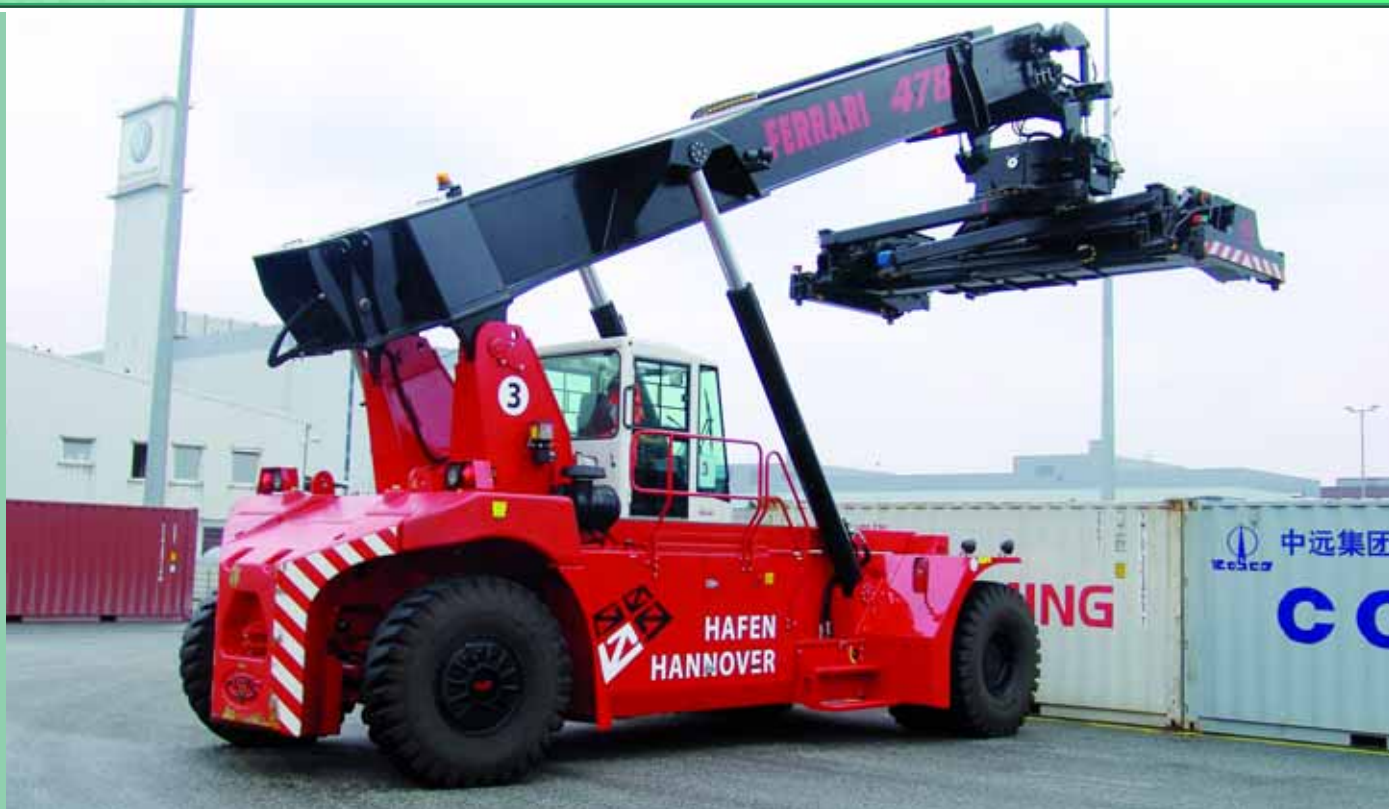
▲ HAUSLIEFERANT Eine Flotte von Ferrari-Reachstackern übernimmt in Hannover den Umschlag von Containern.
