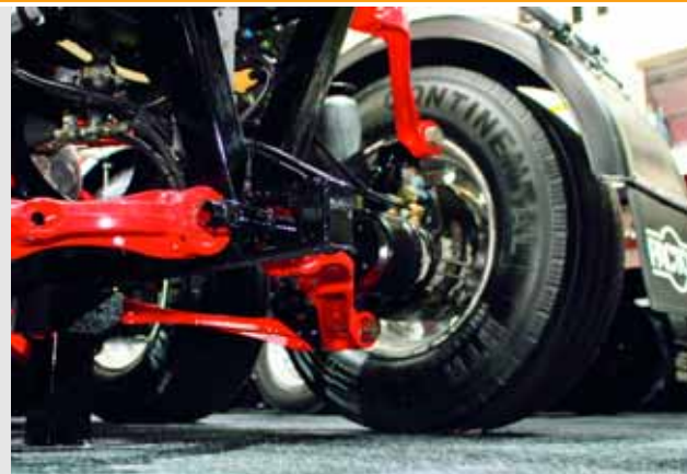
▲ CONTAINERCHASSIS MIT EINZELRADAUFHÄNGUNG: Es gibt Transportsegmente, da kommt es auf Sicherheit an.
