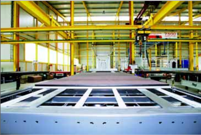
▲ BODENSTÄNDIGE ARBEIT: Die zusätzlichen Längsverstrebungen gibt es exklusiv bei Fliegl.
