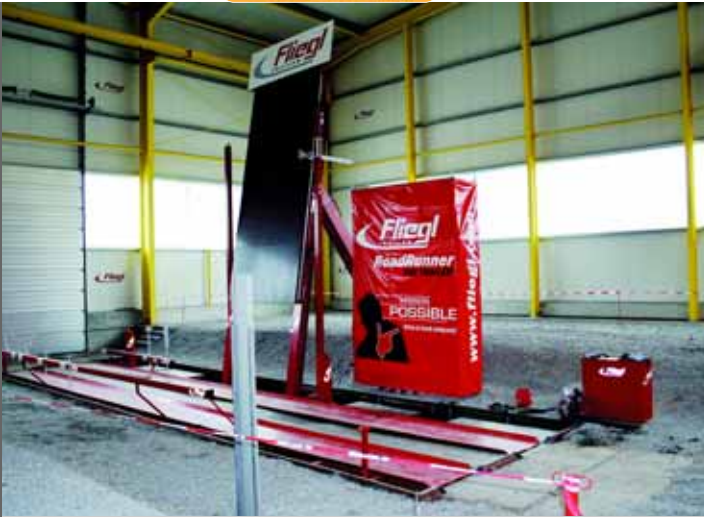
▲ BIS ZUR BITTEREN NEIGUNG: Auf der werkseigenen Testanlage werden auch Fremdfahrzeuge auf ihre Kippsicherheit geprüft.
