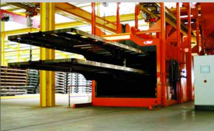
▲ ENTER SANDMAN: Die Sandstrahlanlage im Fliegl-Werk verarbeitet die Fahrzeugrahmen paarweise.
