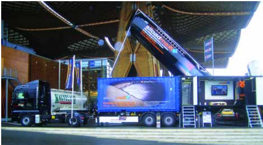
Minutiös verblasen: Das Siloadmaxx-System belädt einen Standard-container innerhalb von 25 Minuten mit 25 t Schüttgut.
