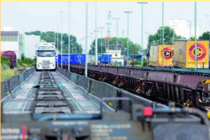
ROLA: Die rollende Landstraße zwischen Regensburg und Trento als eine intermodale Verbindung.
