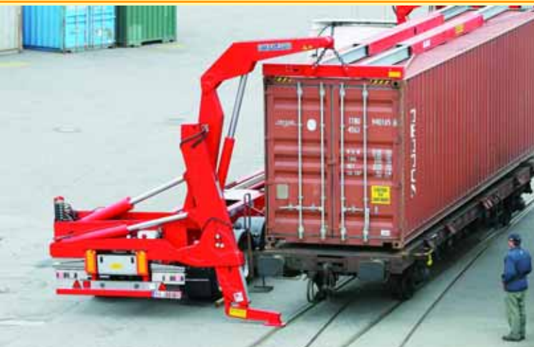
SEITE AN SEITE: Mafo vermietet auch Seitenlader, mit denen die Container vom Tragwagen umgeschlagen werden können.
