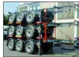
3-Achs-Containerchassis, teleskopierbar, auch mit ADR-Ausstattung, geeignet für 1x 20'-, 2x 20'-, 1x 30'-, 1x 40'- oder 1x 45'-Container.
