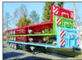
3- bis 5-achsige Tele-Megatrailer, nachlauf- und hydr. zwangsgelenkt, auch mit Containerverriegelungen lieferbar!
