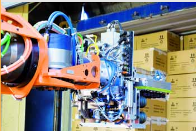
Packt mit an: Der PaketRoboter von ThyssenKrupp Krause entlädt und palettiert Stückgut aus Containern.
